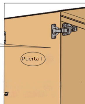
La altura de la puerta y el panel superior deben estar a un nivel paralelo
